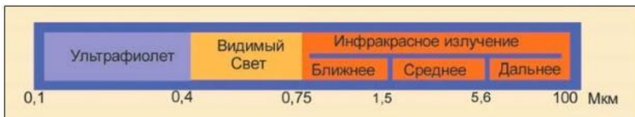
Рис. 1. Составляющие электромагнитного излучения пламени
